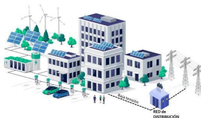
FIGURA 3.2 Autoconsumo colectivo en edificios de viviendas
